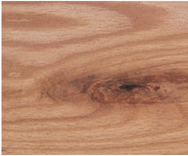
ENTRE-ÉCORCE : Une portion d'écorce incluse dans la masse du bois
