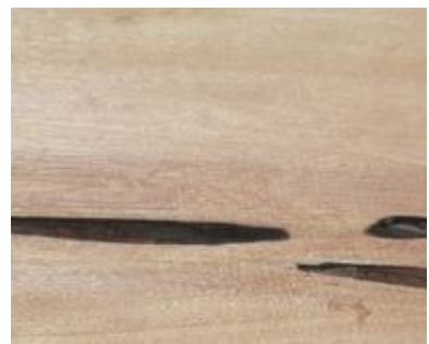
TROUS D'INSECTES : Trous supérieurs à 1/4"
