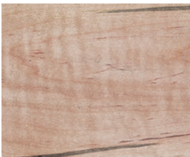
TROUS DE VERS : Trous dans le bois dont le diamètre va de 1/16" à plus de 1/4"
