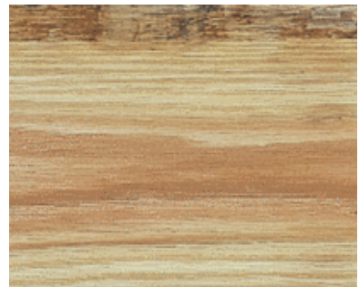
FLACHE : Écorce ou manque de bois en raison de l'arrondi de l'arbre ou de la grume.
