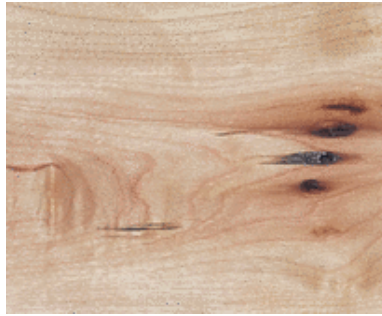
MOUCHETURES : Petits défauts dans le grain dus au piquage du bois par les oiseaux et qui contiennent parfois de l'écorce en croissance. L'American hickory et l'orme font exception à cette règle.
