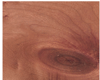
NŒUD SAIN : Un nœud plein sur sa face qui ne porte pas d'indication de pourrissement.
